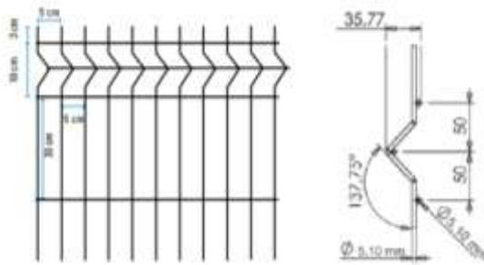
De acordo com o projeto padrão fornecido pelo FNDE (para terreno de 45 x 35 m), haverá fechamento com gradil de 1,58m de altura, com pilaretes metálicos e tela de aço galvanizado de tamanho fixo, instalado na parte frontal do lote, acima de mureta de alvenaria de 0,62m de altura. Caso o terreno disponível seja maior, o ente requerente poderá utilizar-se do padrão de fechamento aqui descrito para a instalação em todo o seu terreno, ficando o custeio do excedente a cargo do requerente.
